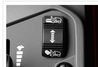
Ouverture et fermeture du bac par simple pression
