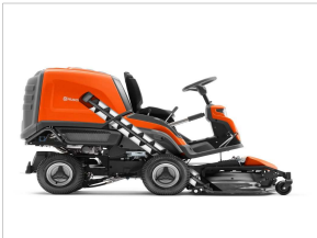
Système de vis sans fin Bac AC-Tech
